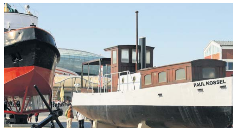
1921 stellte das Bremer Bauunternehmen Paul Kossel einen Motorschlepper aus Beton her. Er liegt heute im Schiffahrtsmuseum Bremerhaven.
