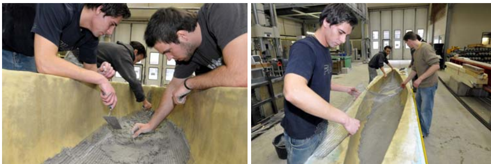
Im Betonlabor der Uni Essen wird der fertige Beton mit der Bewehrung in die Negativ-Form eingelegt.
