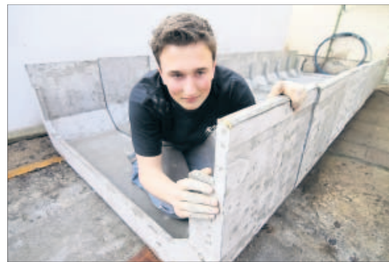
Blick für die Details: Max Hofmann kontrolliert die schon fertigen Bootsteile. Das Drachenboot besteht später aus 16 dieser Segmente.
